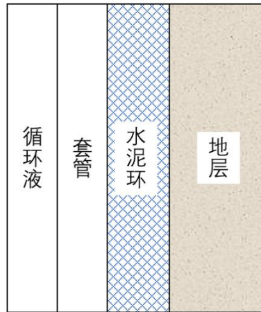
图 3-3 地热井热量传递示意图
